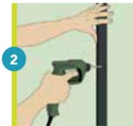
2 Fixe a guia com bucha e parafuso (5" ou brocante para sistema Drywall).
