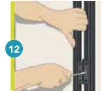
12 Fure os perfis (batentes) instalados nas divisórias e fixe com parafusos (ponta agulha).
