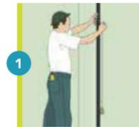
1 Alinhe a guia na parede com o prumo.
