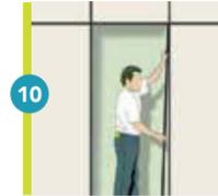
10 Coloque os batentes encaixando-os e fixando-os dentro dos montantes; primeiro o batente superior (horizontal) e depois os inferiores (verticais).
