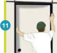
11 A colocação da porta deve ser feita após a instalação da fechadura e das dobradiças; não se esqueça de requadrar a porta com os testeiros (ou fita de borda).
