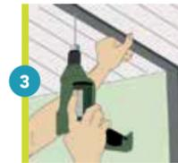
3 Fixe a guia com bucha e parafuso (5" ou brocante para sistema Drywall).
