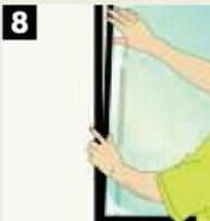
Colocar a baguete de vidro de perfil maior (leito), dentro da travessa e do montante, formando a moldura do vidro.
