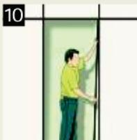
Colocar os batentes encaixando-os dentro dos montantes; colocar primeiro o batente superior (horizontal) e depois os inferiores (verticais).
